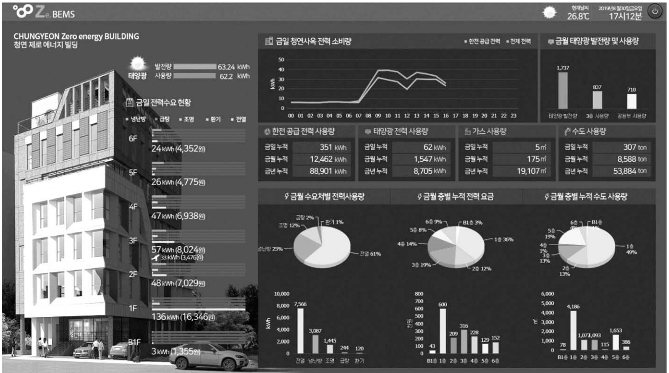
[그림 27] BEMS 종합구성 화면
