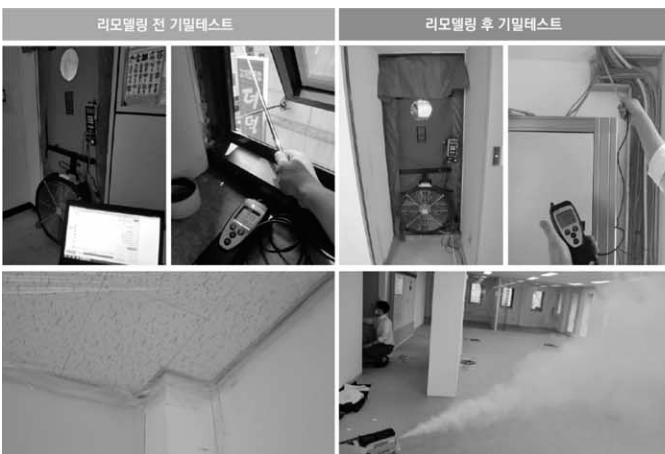
[그림 14] 리모델링 전후 기밀테스트 시행
